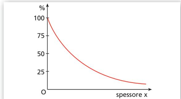
▲ Percentuale dell'intensità della radiazione trasmessa da uno spessore  $x$  di materia, rispetto a quella incidente. L'andamento è esponenziale.
