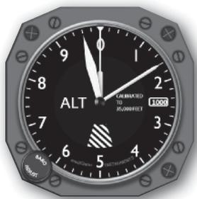
Al livello del mare la pressione atmosferica è di circa 14,7 psi (*pounds for square inch*, unità di misura anglosassone usata anche in campo aeronautico). L'andamento della pressione  $P$  in funzione dell'altitudine  $h$  è espresso dalla funzione  $P = 14,7 \cdot 10^{-0,00018h}$  ( $P$  è misurata in psi;  $h$  in *feet*, «piedi», simbolo ft).
